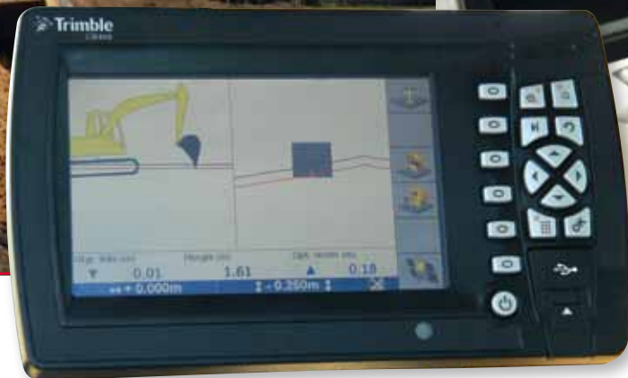
Stefan van de Waardt (hoofd tekenkamer): „Een prachtig systeem en een enorme vooruitgang.” Links de controlbox waarop de machinist exact ziet wat hij doet.
